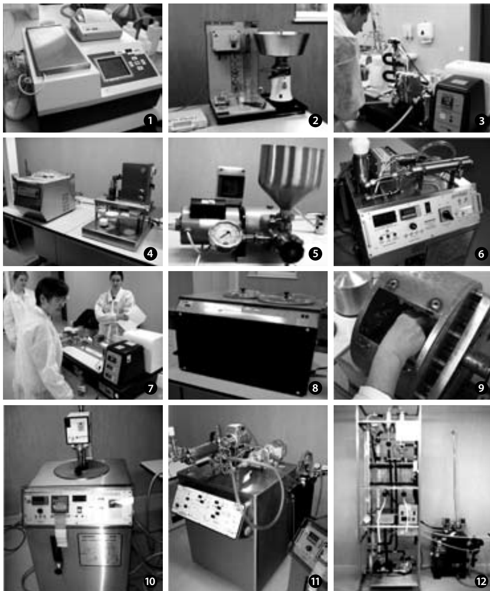
Joonis 2 • Mikromeierei seadmeid: 1 – piima analüsaator, 2 – separaator, 3 – pastörisaator, 4 – kile- ja topsipakendamise seadmed, 5 – homogenisaator, 6 – membraantehnoloogiline filtaratsiooniaparaat, 7 – juustuvann (kuulub Tervisliku piima biotehnoloogiate TAKile), 8 – sublimatsioonkuivati (lüofilisaator), 9 – tsükkeltoimeline võimasin, 10 – multifunktsionaalne tank, 11 – jäätisefriiser, 12 – vaakumaparaat koos aurugeneraatoriga
